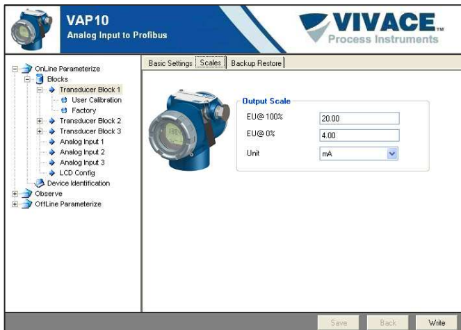
Figura 3.7 – Tela de configuração da saída do Transducer.
