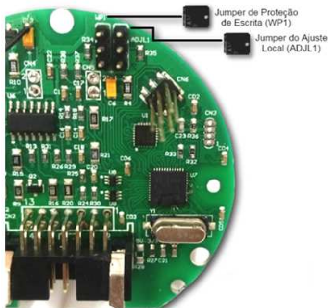
Figura 3.2 – Detalhe da placa principal com jumpers.
