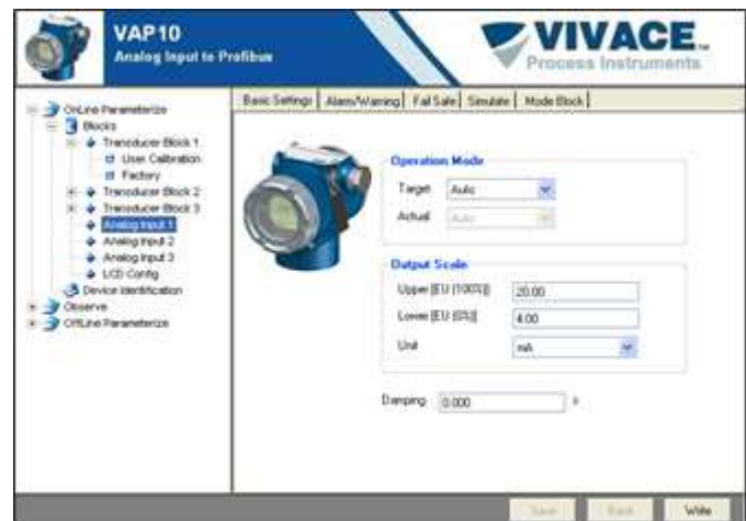
Figura 3.8 – Tela de configuração do Bloco AI.
