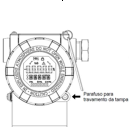
Figura 2.2 – Trava da tampa com visor.
